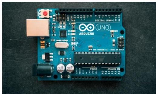
**FIG 03 ARDUINO UNO BOARD**
